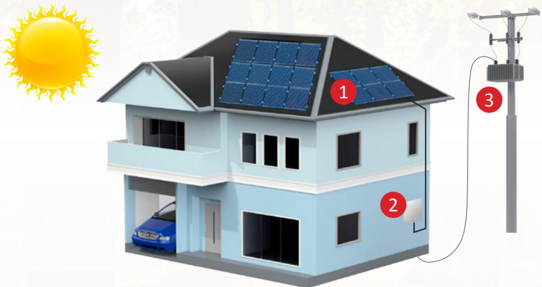
1. Mithilfe von PV-Modulen, die aus einzelnen PV-Zellen bestehen, wird das Sonnenlicht eingefangen und in sauberen Gleichstrom umgewandelt. Das funktioniert auch an bewölkten Tagen, da hierfür kein direktes Sonnenlicht benötigt wird.
